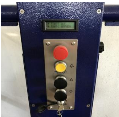
Contrôle sur plateforme avec bouton d'arrêt, alarme et afficheur
