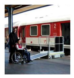
L'élévateur Pégase fonctionne en 24 volts sur batteries, et se recharge grâce à un transformateur branché sur une simple Les rampes d'accès sont réglables en largeur, ce qui permet de s'adapter aux largeurs de portes variables.
